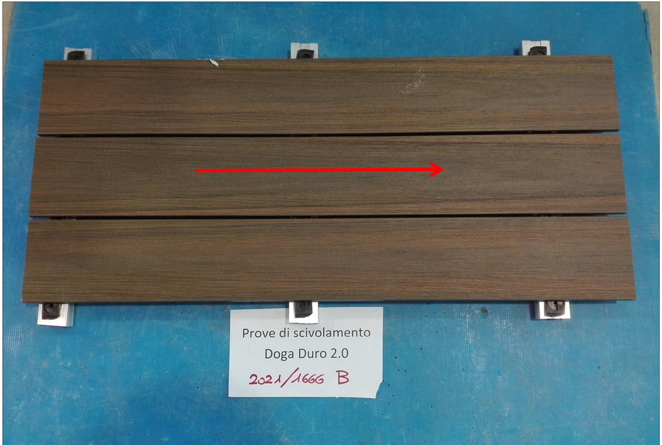
Fotografia dell'oggetto con indicazione della direzione di prova
