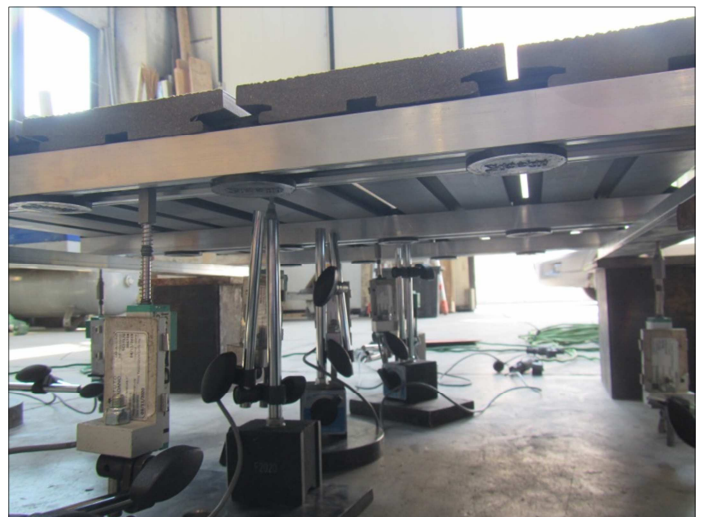
Fotografie dell'oggetto con la disposizione degli strumenti di misura dello spostamento
