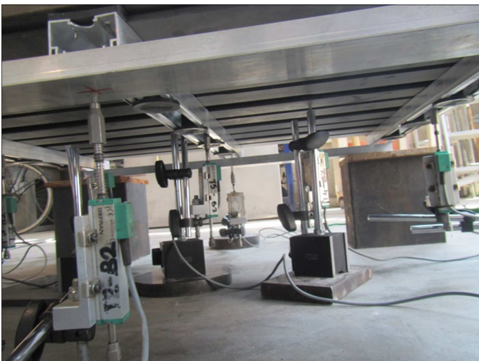
Fotografie dell'oggetto con la disposizione degli strumenti di misura dello spostamento
